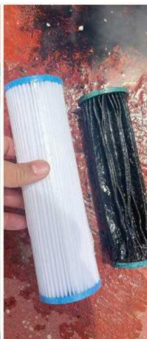
■ Los filtros son insuficientes para tratar el líquido.
